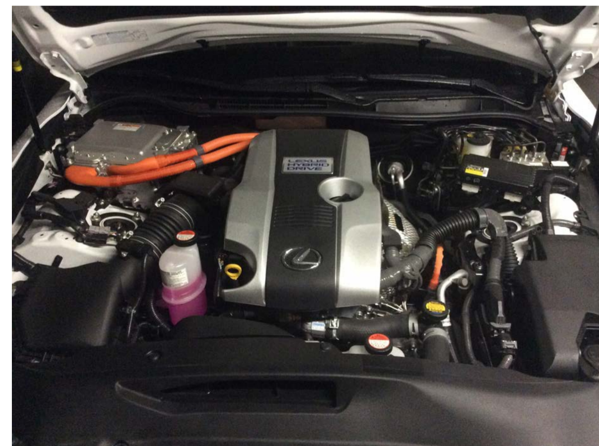
Komora silnika Lexusa IS300h, tym razem moduł PCU jest umiejscowiony z lewej strony przy podszybiu.
