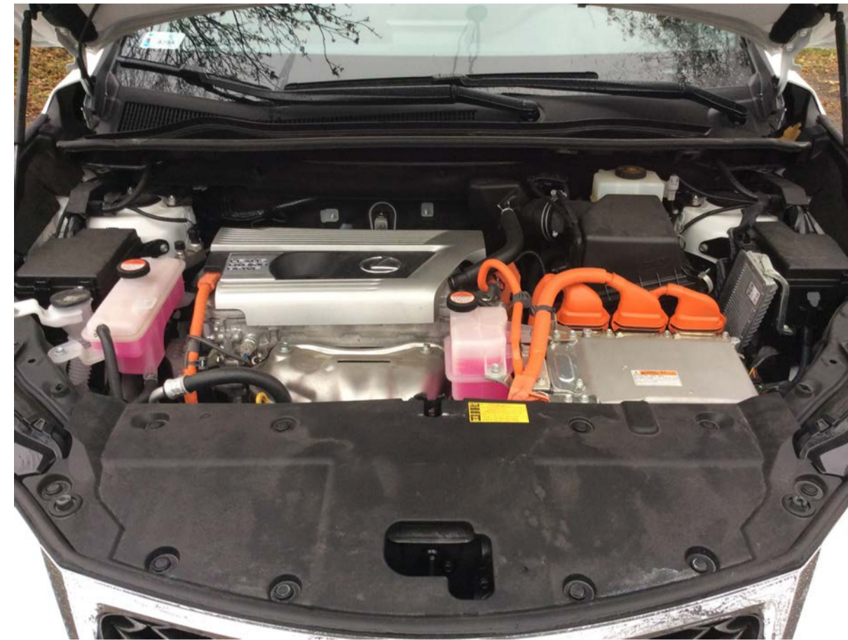
Komora silnika Lexusa NX300h, z modułem PCU umieszczonym z przodu pojazdu po lewej stronie.
