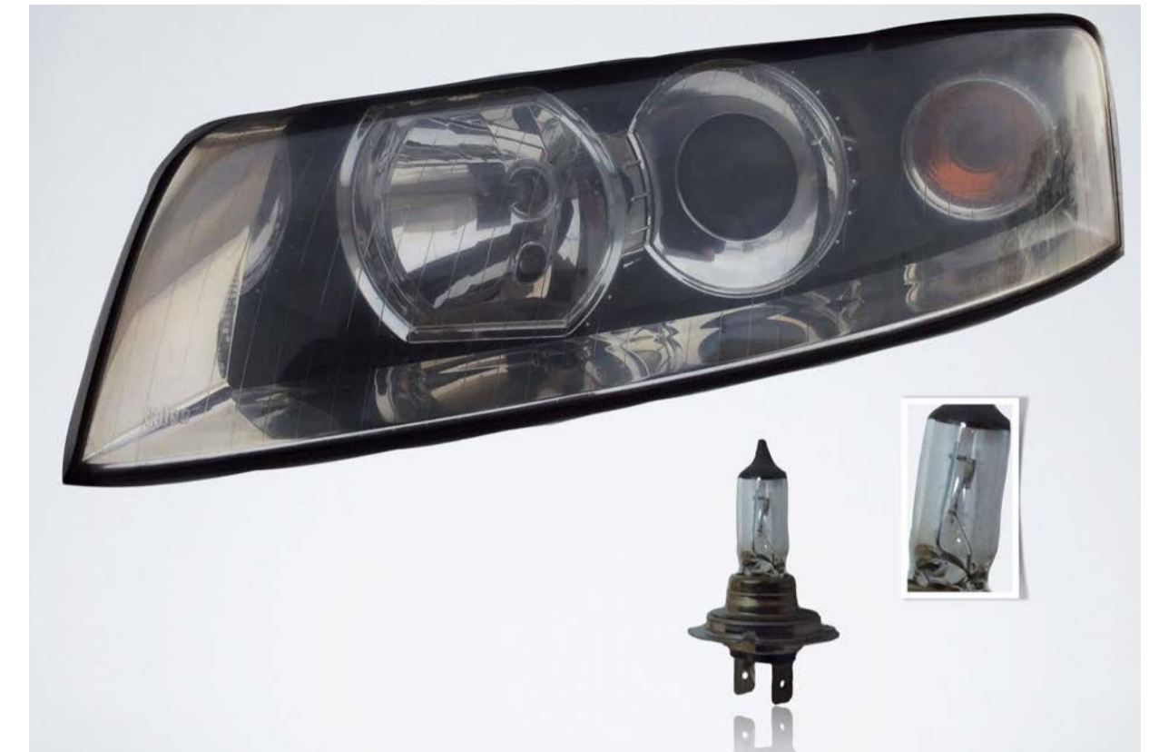
Reflektor halogenowy współczesny, żarówka halogenowa H7
