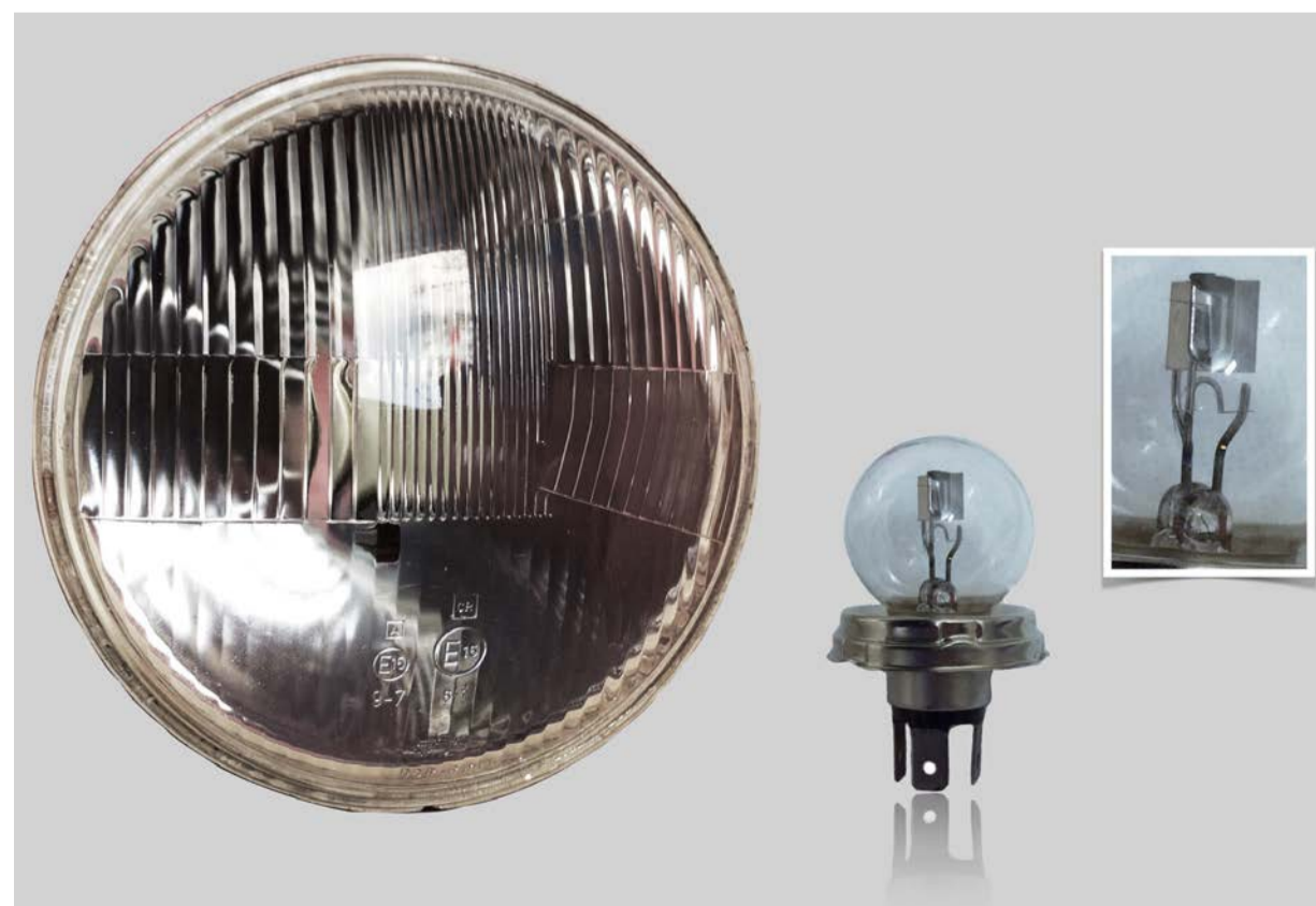
Reflektor asymetryczny stosowany w latach 50. ubiegłego wieku, żarówka próżniowa dwuwłóknowa.
