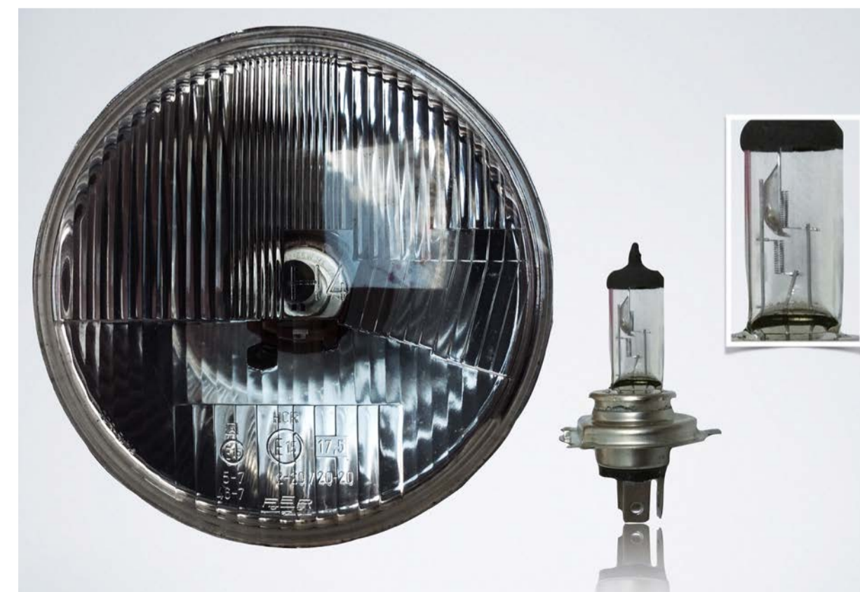
Reflektor halogenowy stosowany w latach 70-tych ubiegłego wieku, żarówka halogenowa H4.
