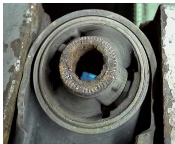
Tuleja metalowo-gumowa zamontowana w wahaczu na pierwszy rzut oka nie wydaje się uszkodzona.
