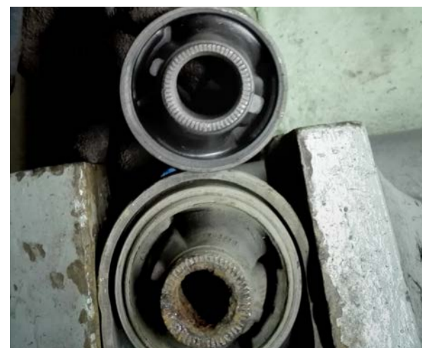
Porównanie nowej i starej tulei. Zużyty element jest wyciskany, a nowy silentblock wprasowywany do wahacza.
