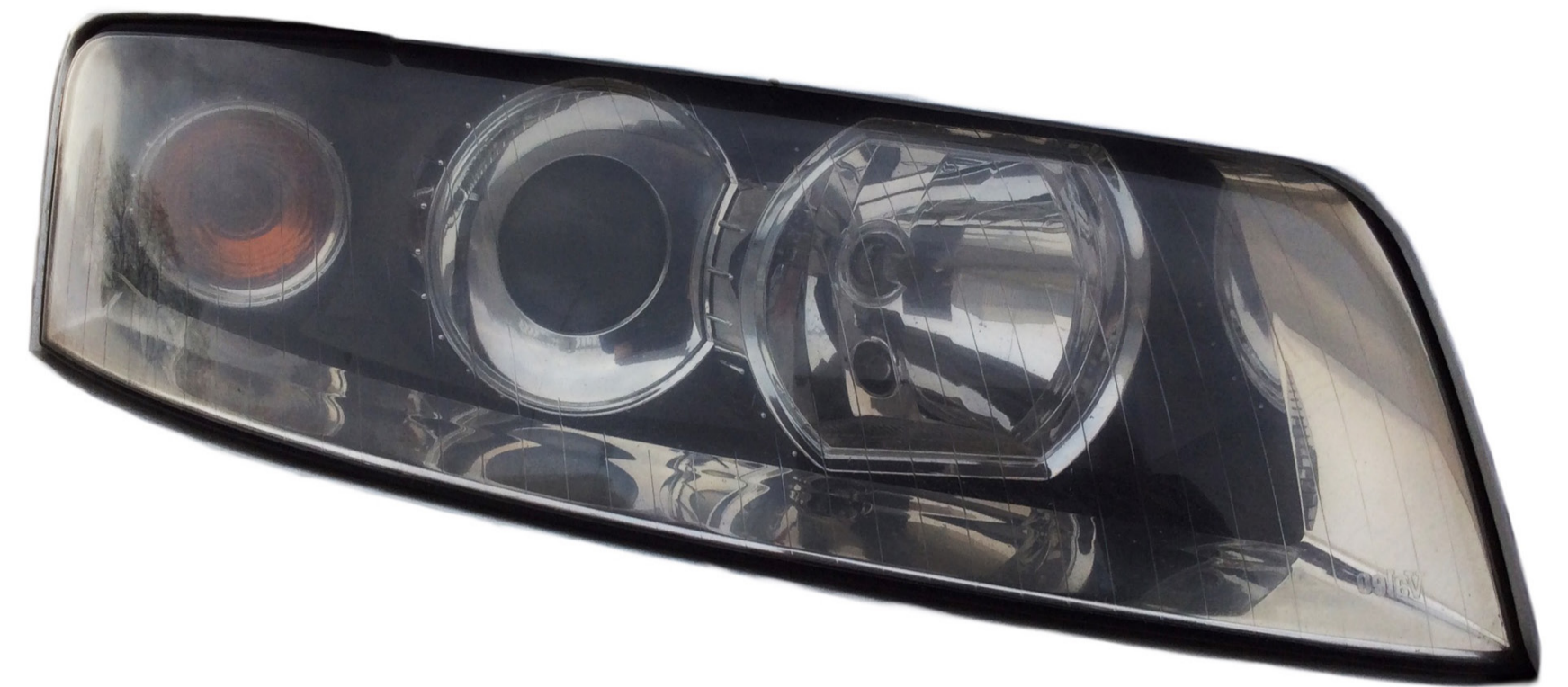
Reflektor halogenowy z żarówką H7 ( światła drogowe) i lampą wyładowczą świateł mijania.
