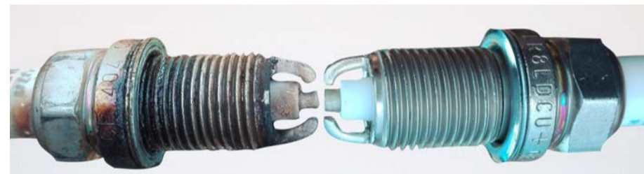
Porównanie świecy zapłonowej po przebiegu 18 tys km i świecy nowej
