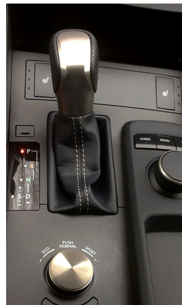
Lewarek dźwigni zmiany biegów bezstopniowej skrzyni. Wybór trybów jazdy w trybie automatycznym: P,R,N,D jak i trybie sekwencyjnym.
