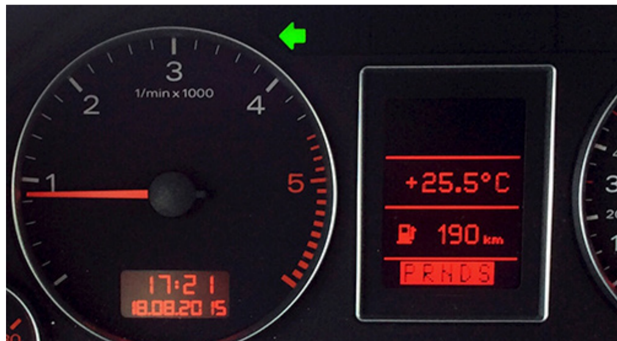
Sygnalizacja trybu awaryjnego skrzyni bezstopniowej w Audi A4 model B7. Podświetlone na czerwono pola wyboru trybu jazdy.
