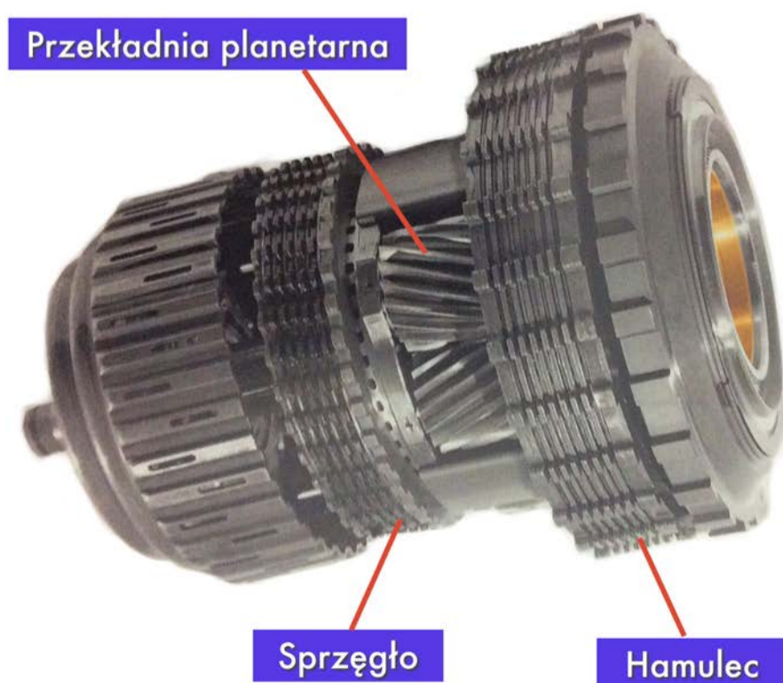
Elementy przełączające automatycznej skrzyni biegów. Skrzynia biegów 6-biegowa Tiptronic.
