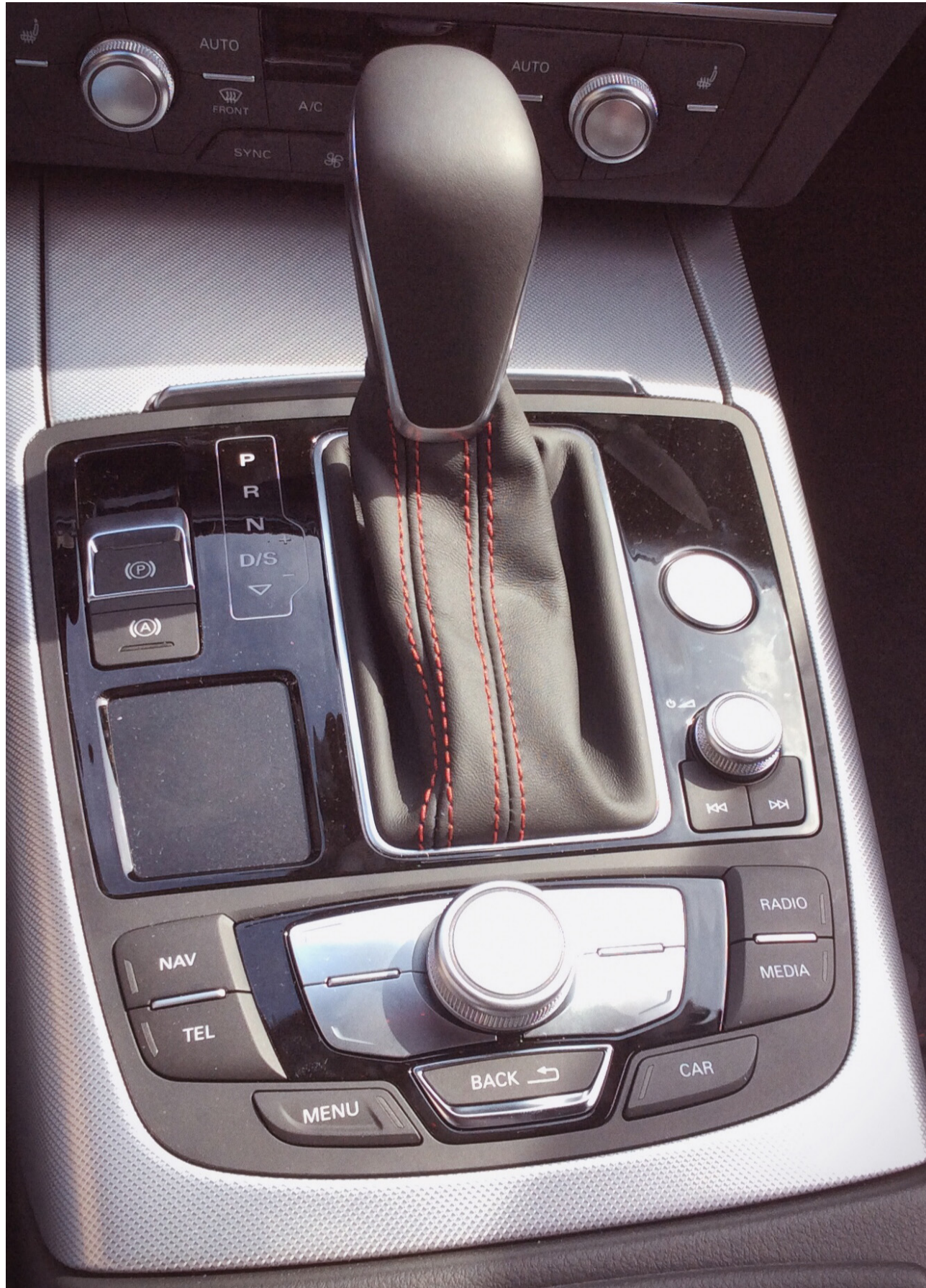
Audi A6 z S tronikiem czyli dwusprzęgłowa, 7-biegowa automatyczna przekładnia.
