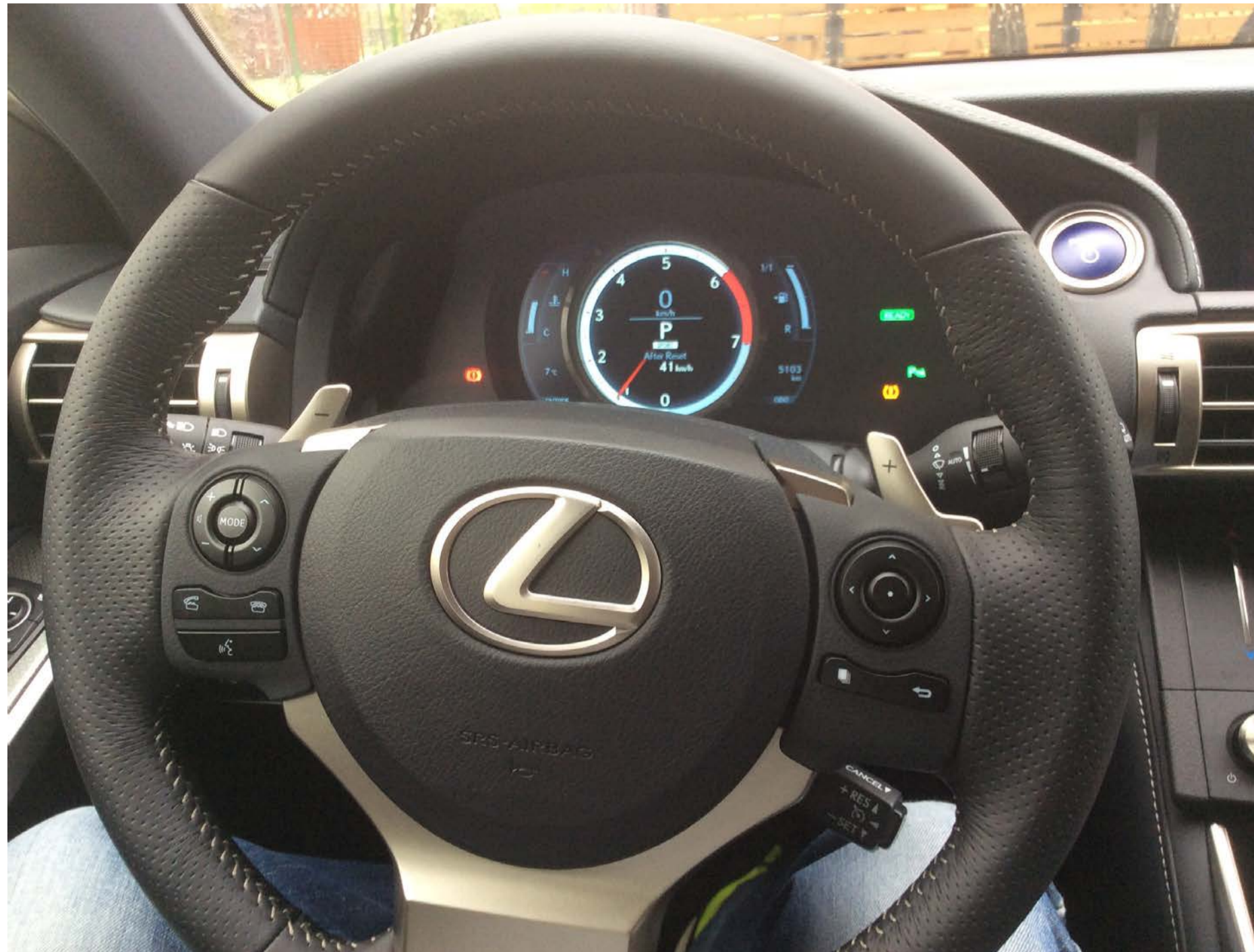
Lexus IS 300h kierownica z możliwością zmiany biegów za pomocą łopatek - automat plus napęd hybrydowy.
