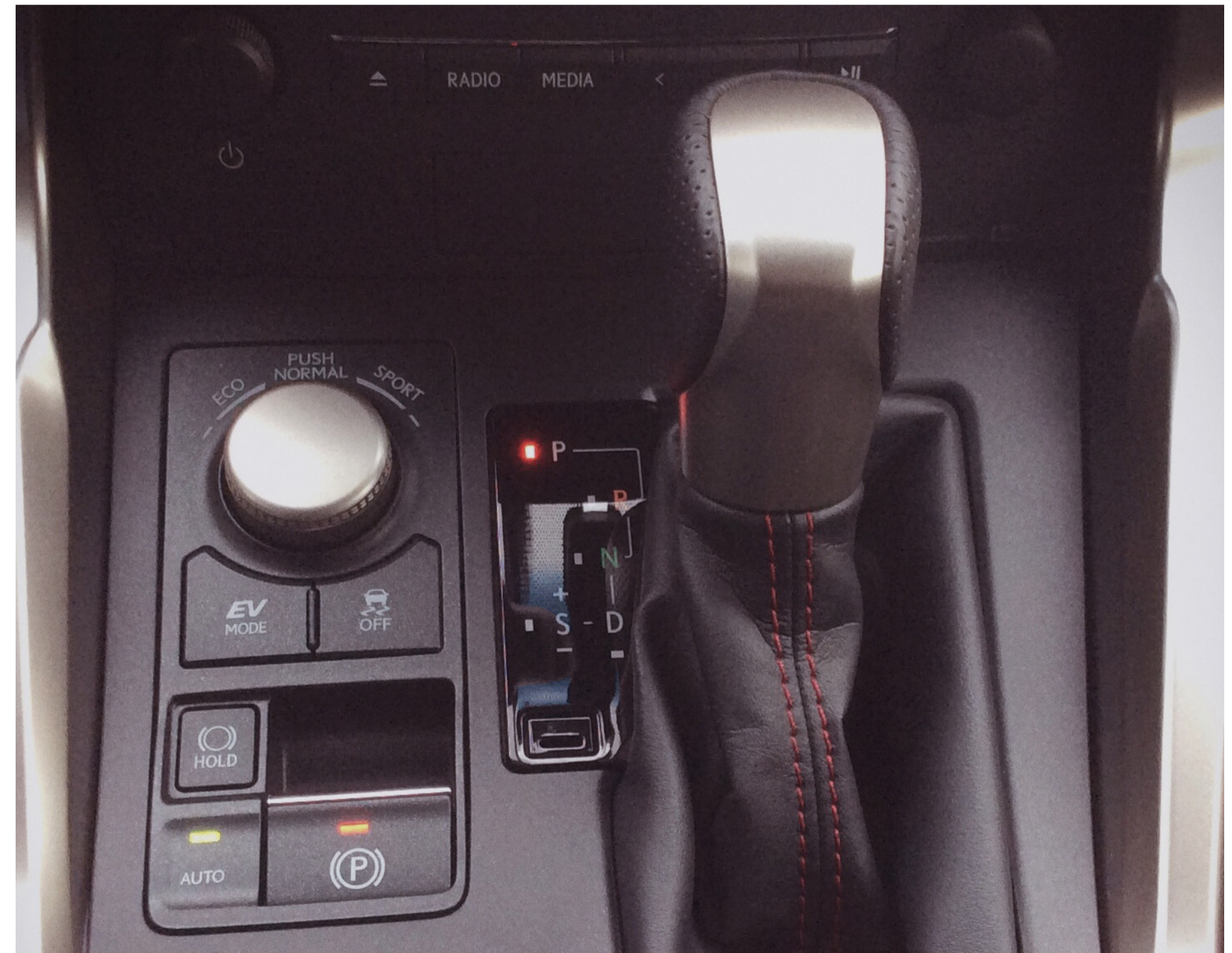
Lexus NX 300h lewarek zmiany biegów skrzyni bezstopniowej CTV. Selektor wyboru trybu jazdy w formie pokrętła po lewej stronie.
