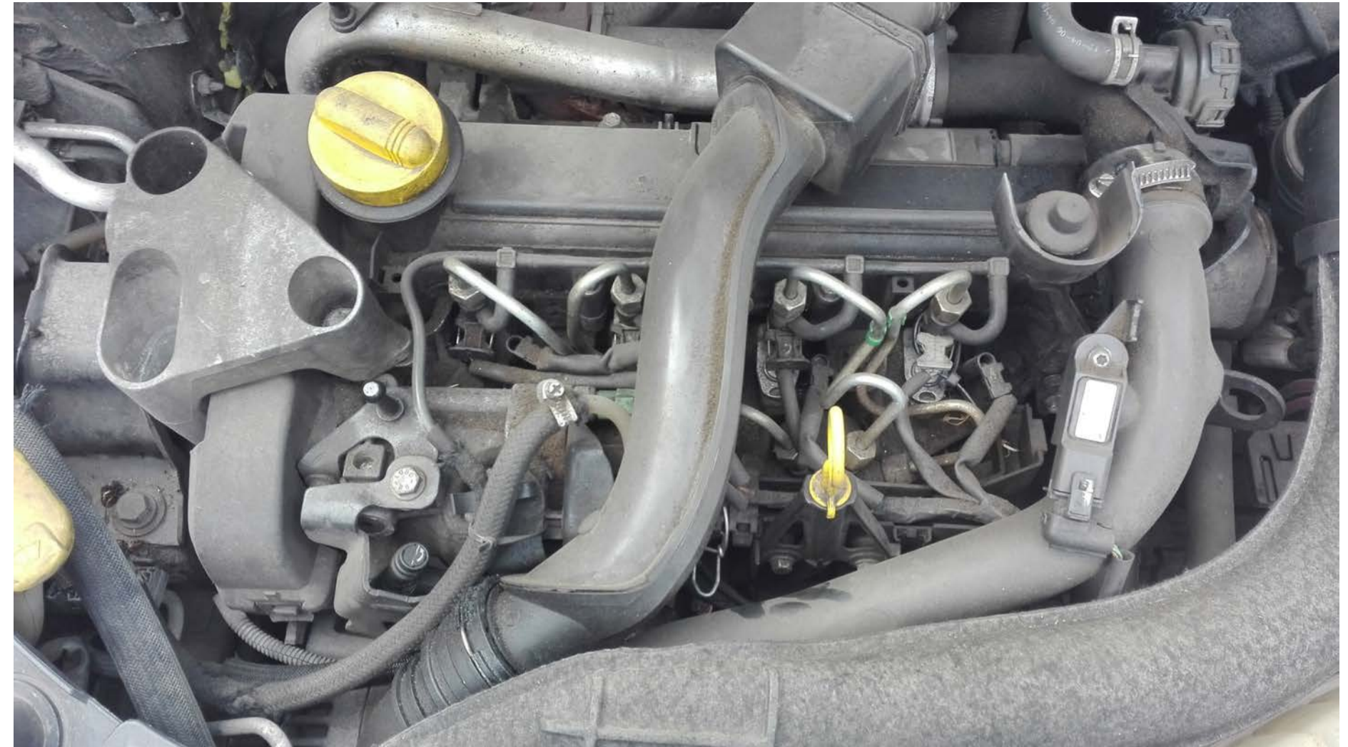
Niezwykle popularny 1.5 cdi w Renault Clio trzeciej generacji, oczywiście posiada układ wtryskowy typu Common Rail francuskiego koncernu PSA.
