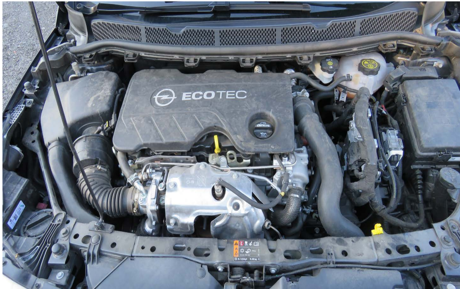
Opel Astra piątej generacji z silnikiem 1.6 CDTi o mocy 136 KM, z boschowskim Common Rail.
