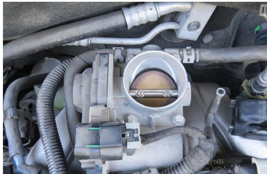
Elektroniczna przepustnica współpracująca z układem chłodzenia silnika.
