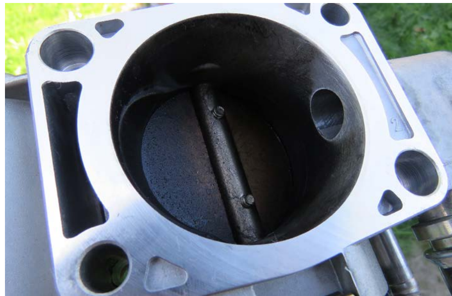
Zanieczyszczenia przepustnicy widoczne na zdjęciu tylko w średnim stopniu zakłócały pracę systemu - jednak przynajmniej raz w roku warto przeczyścić zespół.
