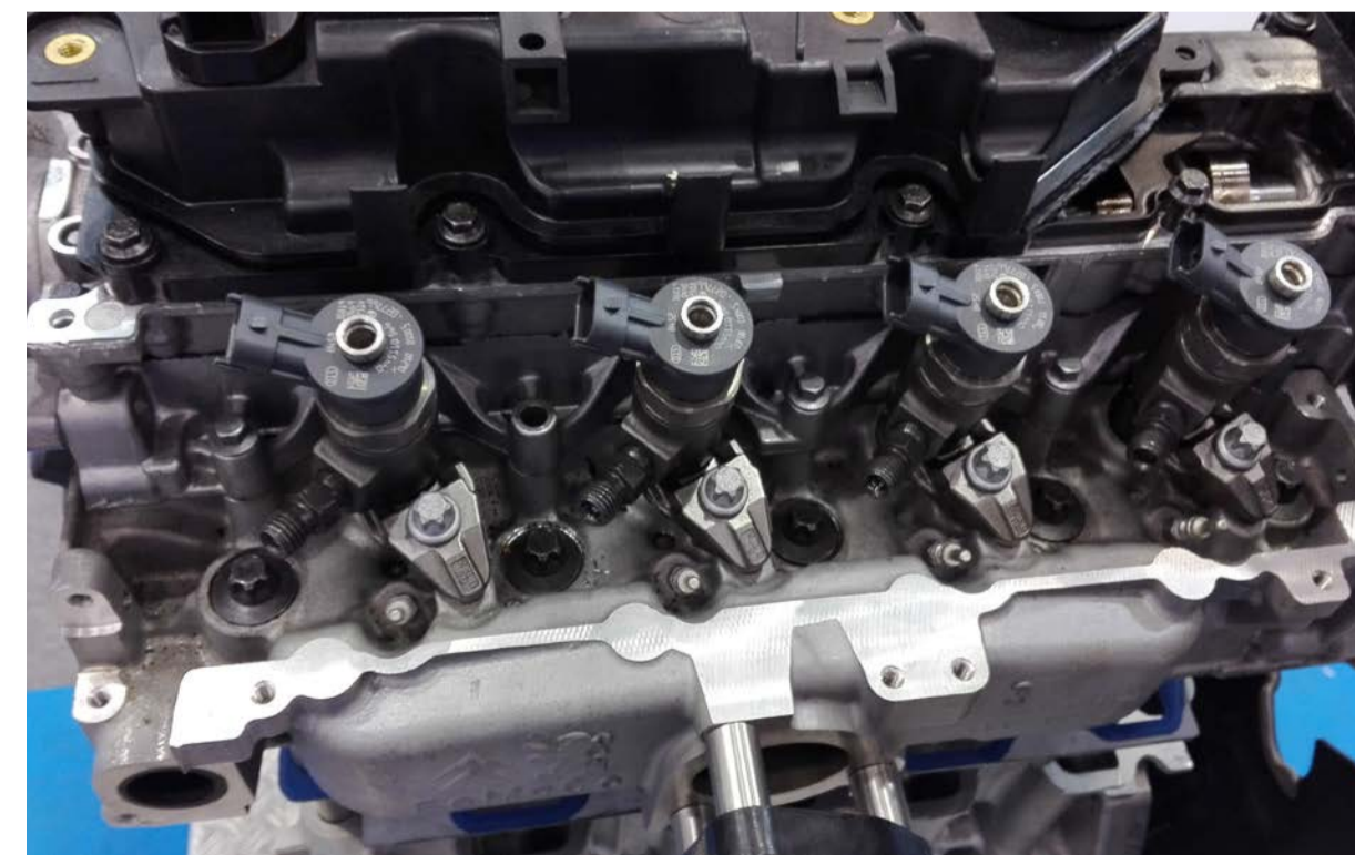
Wtryskiwacze systemu common rail drugiej generacji sposób zabudowania w silniku.
