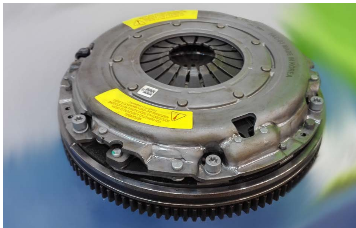
Zestaw dwumasowego koła zamachowego ze sprzęgłem samonastawnym.
