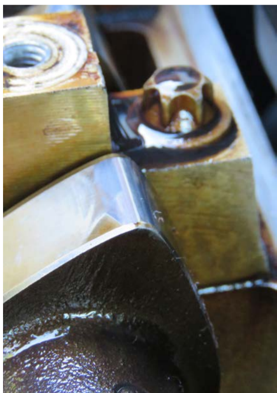
2. Ślady zużycie wałka rozrządu wynika z przebiegu ponad 250 000 km.
