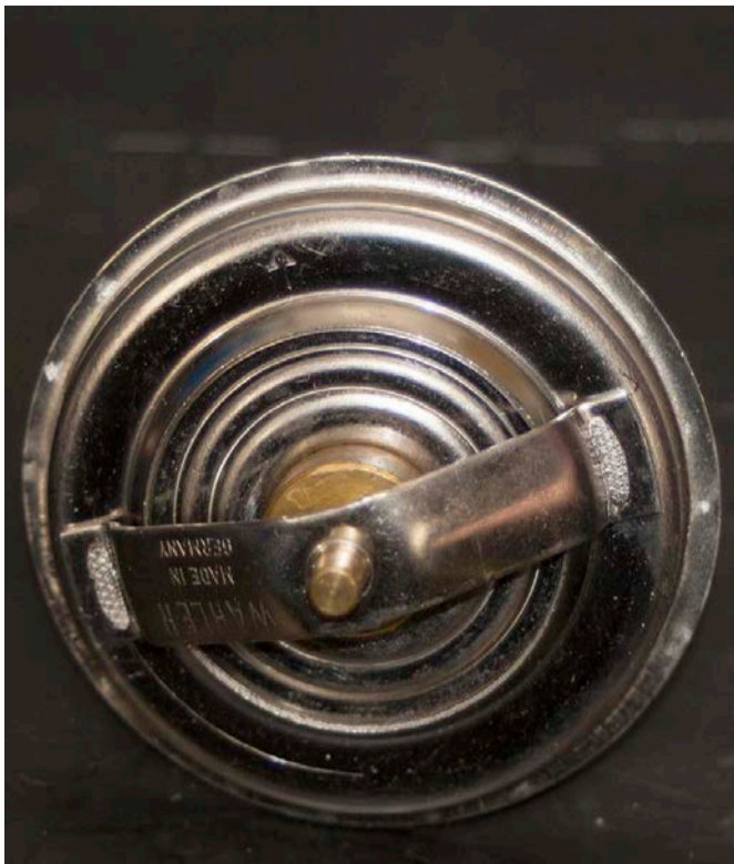
Termostat - czyli zawór sterowany temperaturą. Ten niedrogi element układu chłodzenia może być powodem całkiem dużych kłopotów.
