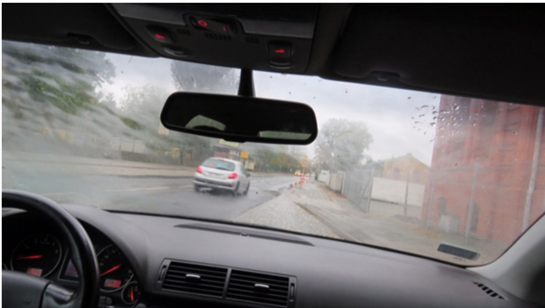
Problemy z odparowywaniem szyb mogą być spowodowane brakiem termicznej wydajności układu chłodzenia.
